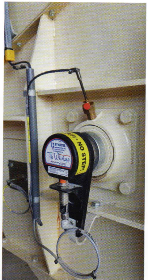
Afb. 5 Lager-temperatuursensor op een elevatorvoet
